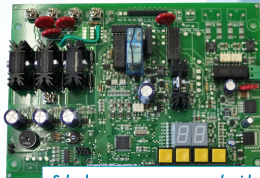
Scheda emergenza per quadro idraulico
